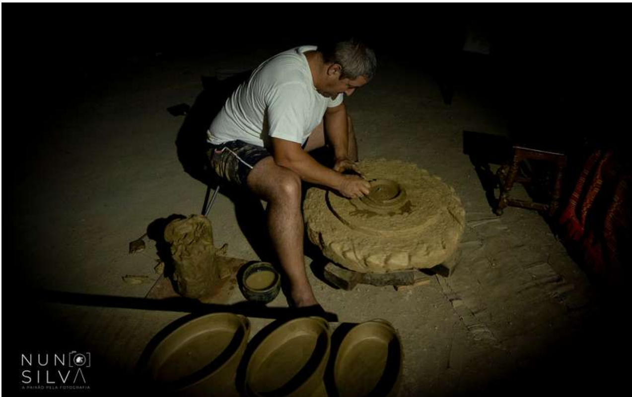
Figura 20. Associada à roda do oleiro está sempre agregada uma "banc" ou tripé construído em madeira e em forma de meia-lua onde o oleiro se senta
