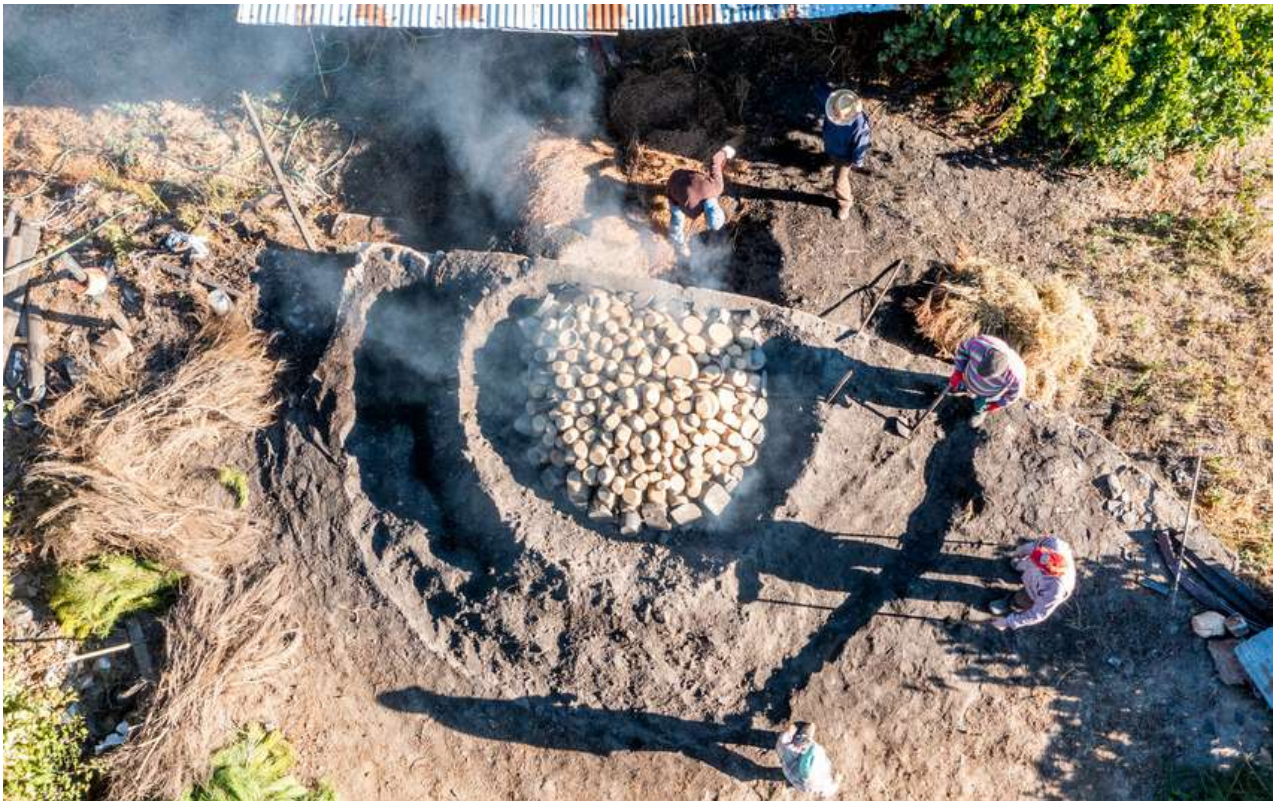
Figura 5. Forno cerâmico que evoluiu do primitivo sistema de "soenga"
