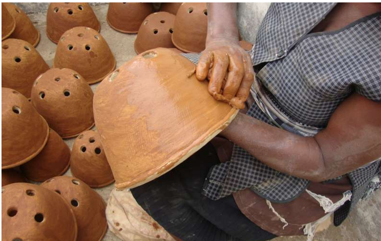
Figura 55. Tratamento com água avermelhada que confere a cor característica às peças
